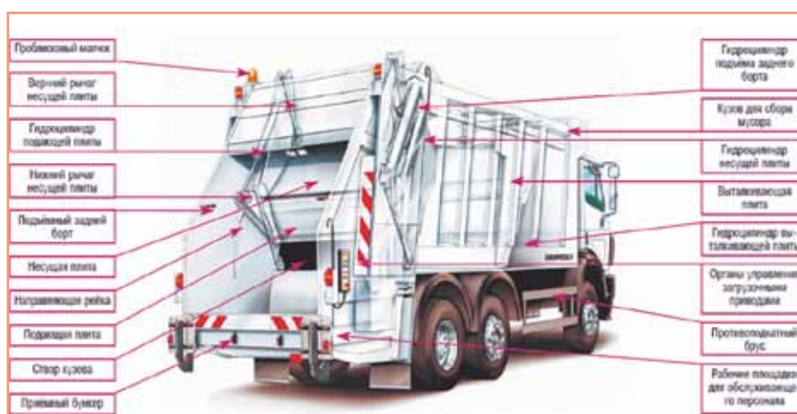
Рис. 2. Пример устройства мусоровоза с задней загрузкой
