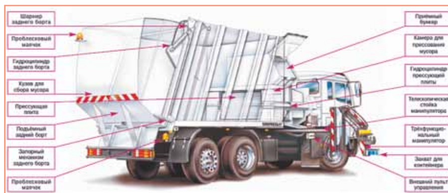
Рис. 1. Пример устройства мусоровоза с боковой загрузкой
