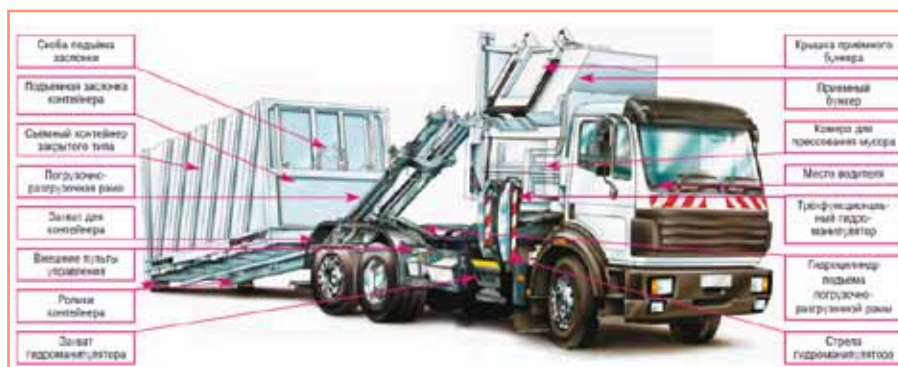
Рис. 4. Пример устройства контейнерного мусоровоза
