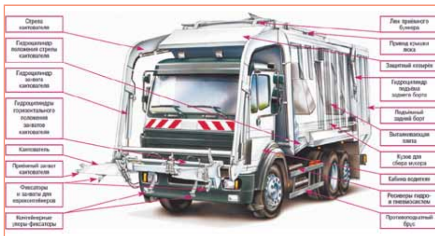
Рис. 3. Пример устройства мусоровоза с фронтальной загрузкой
